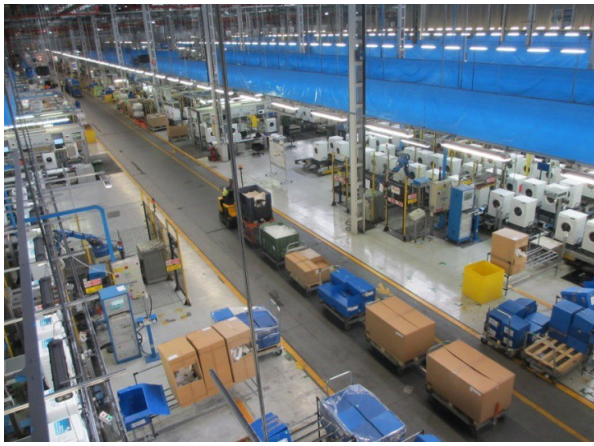
Panoramica della linea di montaggio dello stabilimento di Porcia ed alimentazione dei componenti sulla stessa mediante trenino.
